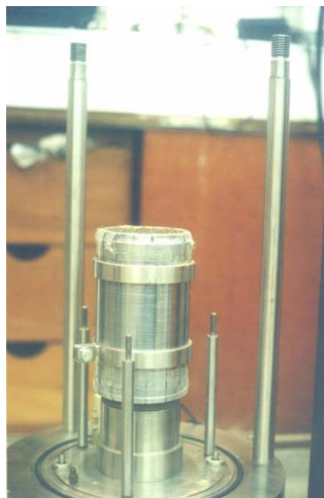
Foto III.18 – Posicionamento do molde tripartido na prensa.
