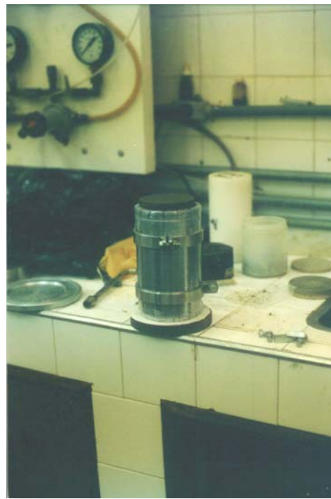
Foto III.16 – Posicionamento de pedra porosa no topo do molde tripartido.
