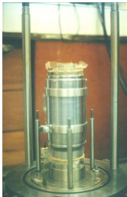
Foto III.20 – Fixação do plástico no “top-cap” e na base da prensa.
