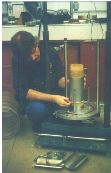
Foto III.24 – Colocação dos elásticos de fixação da membrana na base.
