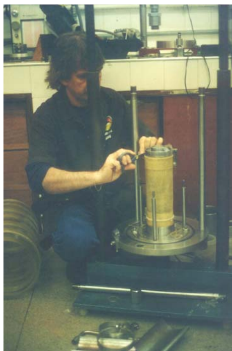
Foto III.25 – Dobra e ajuste da altura da membrana ao “top-cap” e corte do excedente de plástico.
