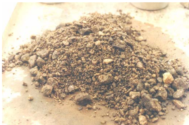
Foto III.10 – Am. de lastro do trecho OC, prof.=0,0 a 20cm, material passante na peneira de 1", umedecido com água.
