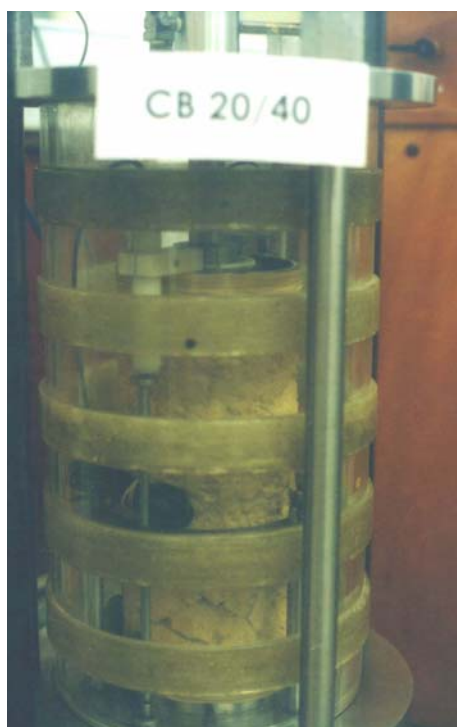
Foto III.26 – Visão da célula triaxial montada com o ensaio em andamento.
