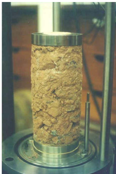
Foto III.6 – Corpo-de-prova com amostra da profundidade de 20 a 40cm do trecho Costa Barros/Pavuna.
