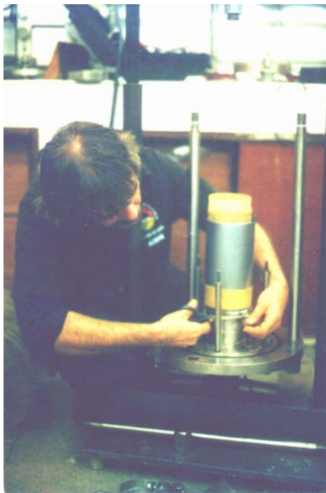
Foto III.23 – Remoção dos elásticos na base e corte do excedente de plástico.
