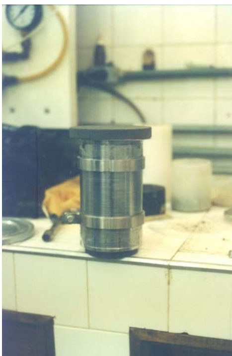
Foto III.17 – Inversão do molde tripartido para colocação na prensa.
