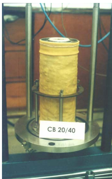
Foto III.5 – Corpo-de-prova com amostra da profundidade de 20 a 40cm do trecho Costa Barros/Pavuna envolto pela membrana.
