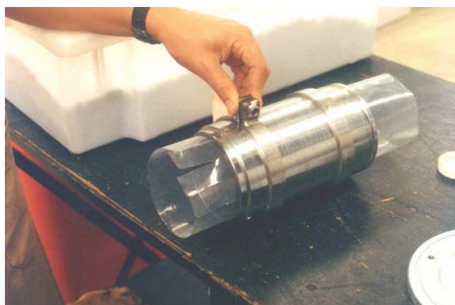
Foto III.7 – Colocação de um pedaço de plástico, extraído de um saco para coleta amostras de lastro, no interior do molde tripartido.
