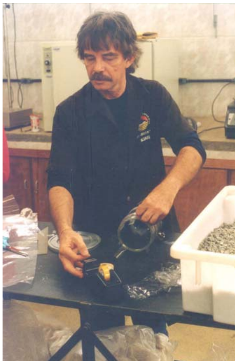
Foto III.8 – Fixação do plástico na parte externa do molde tripartido.
