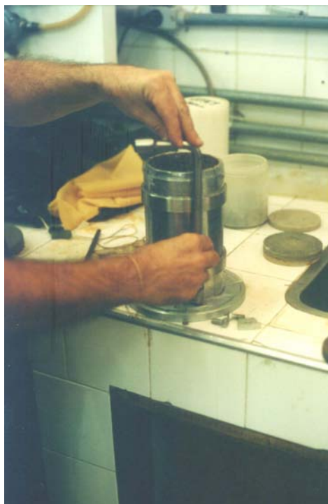
Foto III.13 – Desconexão da base do molde tripartido.
