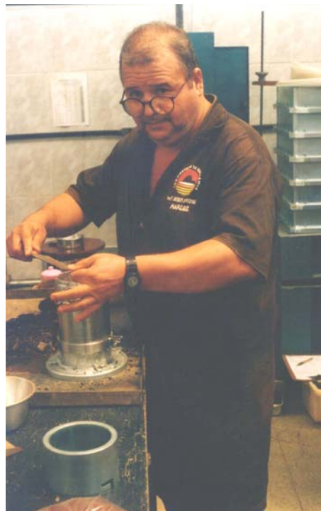
Foto III.12 – Acerto do topo da amostra com molde tripartido.
