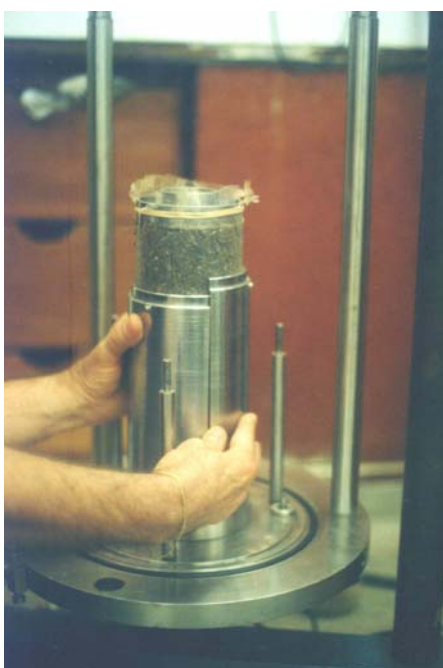
Foto III.21 – Remoção do molde tripartido.
