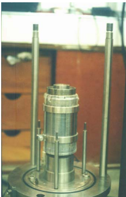
Foto III.19 – Colocação do “top-cap” sobre o molde tripartido.
