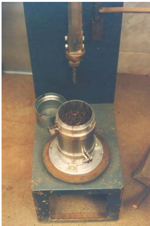
Foto III.11 – Máquina para compactação da amostra no molde tripartido.
