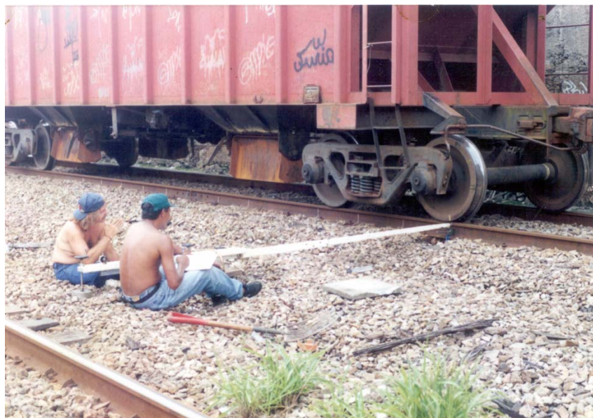
Foto III.2 – Ensaio de viga Benkelman.
