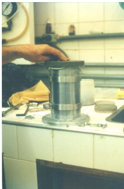
Foto III.14 – Colocação de filtro de papel e disco auxiliar no topo do molde tripartido.
