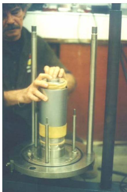
Foto III.22 – Colocação da membrana.
