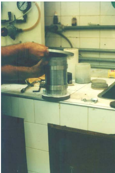
Foto III.15 – Inversão do molde para remoção da base.
